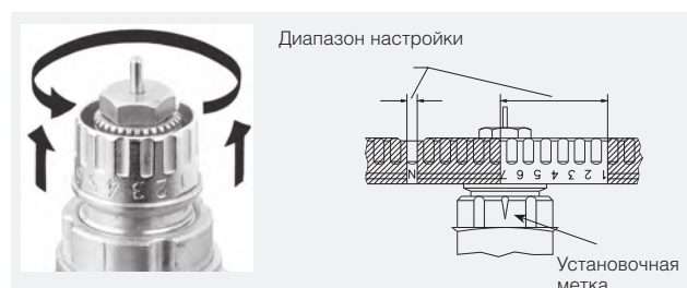
Рис. 11. Предварительная настройка клапана Danfoss
